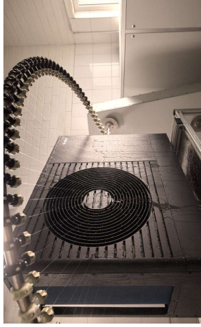
Splash-test for beskyttelse selv ved ekstrem regn
