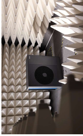
EMC-test for at udelukke elektromagnetisk stråling
