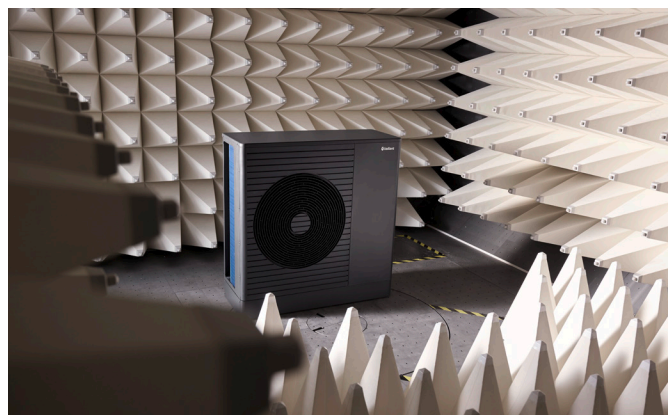
EMC-test for at udelukke elektromagnetisk stråling
