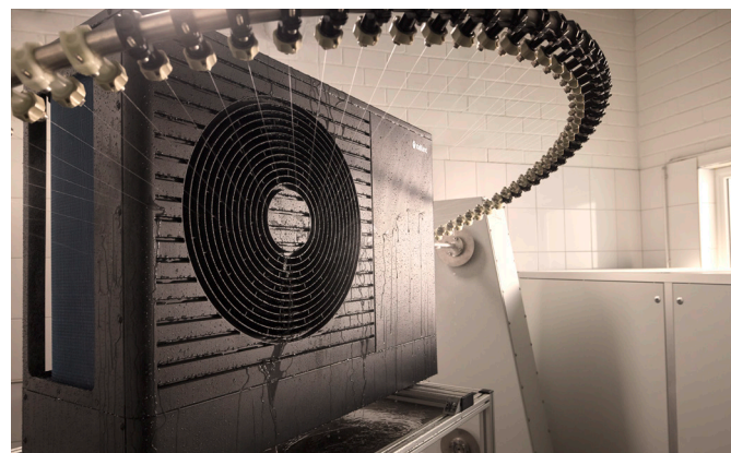
Splash-test for beskyttelse selv ved ekstrem regn
